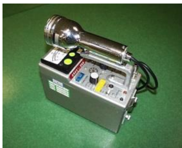
TGS-113 型端窓 GM 計数管式サーベイメータ ^{36}\text{Cl} に対する機器効率：49%
