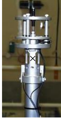
図1 中性子照射装置の線源保持部分（線源位置：×印）
