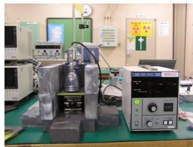
測定の様子 (バックグラウンド計数率を下げるため計数管周囲に鉛ブロックを設置)
