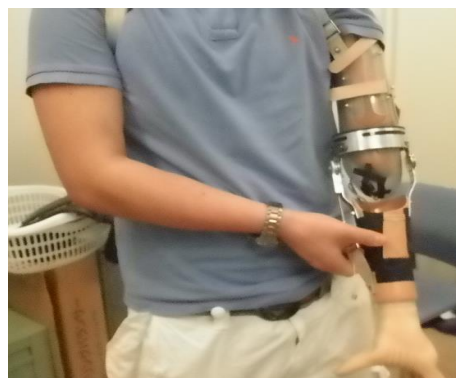
図2 PUSHスイッチによる開き動作
