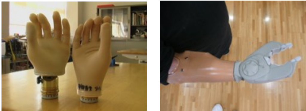
図5-15 左図内：右が通常のデジタルハンド、左はリスト屈曲つきDMCハンド 左：DMCグライファー
