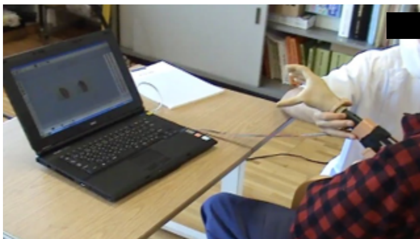
図4-7 上：2chから4chへ変えるため、ハンドと仮ソケットの間にもう一つ装置を挟みこみマイオソフトで出力確認を行う。
