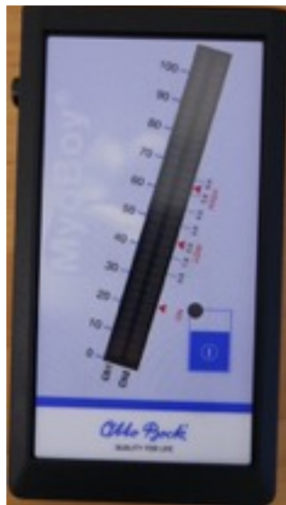
図4-1 マイオボーイ本体 右が新しいタイプ PCとの接続端子（RC232からUSB）へ変更された。
