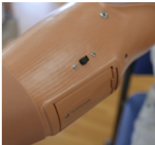
図7-30 リストローテーター・スライドスイッチ（前腕） 前後にスライドすることで、ON-OFF出来る。
