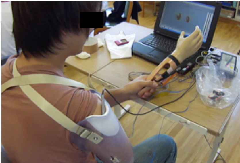
図4-6 マイオボーイと実機を組み合わせで訓練する。図では、仮ソケットに電極を組み込んで行っている
