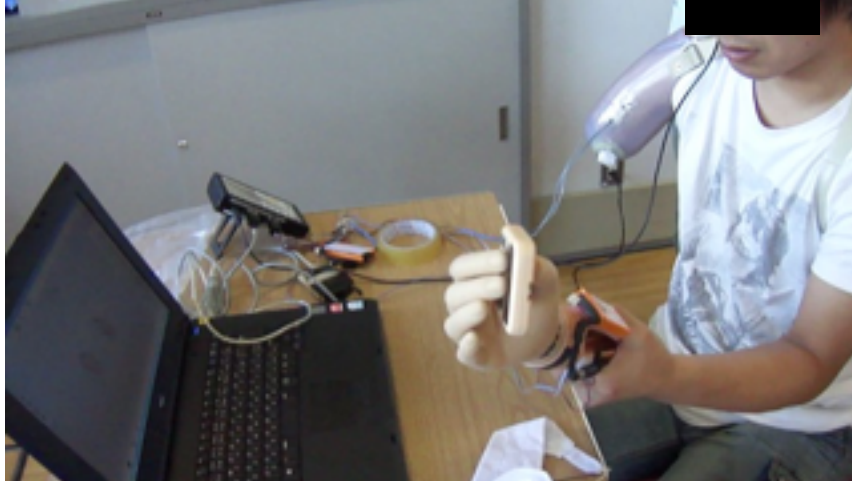
図4-8下：実際にリストローテーターを組み込んで、ハンドの動きを見る。
