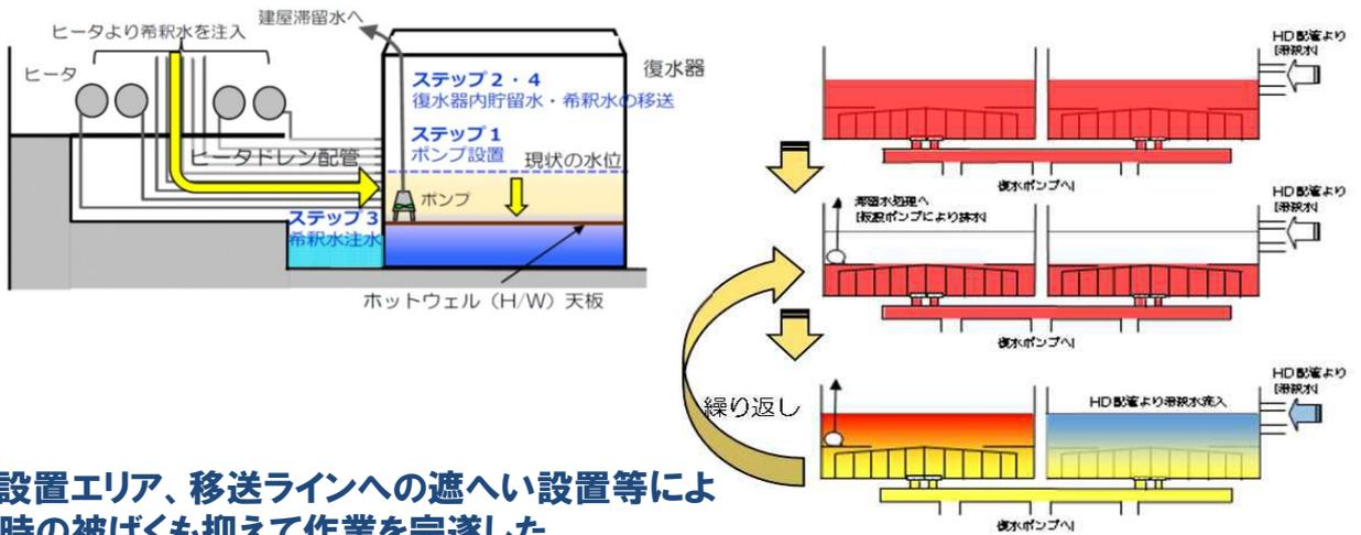
ポンプ設置エリア、移送ラインへの遮へい設置等により作業時の被ばくも抑えて作業を完遂した。
