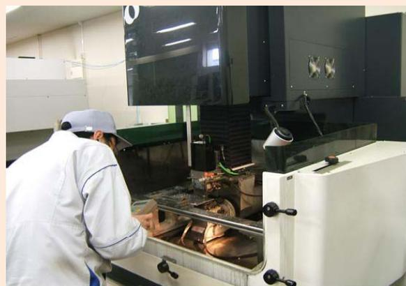
ワイヤカット放電加工による加工
