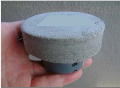
石綿ビニール管 (マンション等耐火部の配管に使用)
