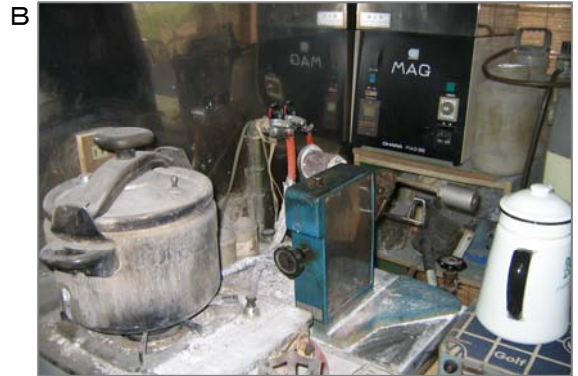
②作業室イメージ。歯科技工の作業は歯科技工士だけではなく歯科医も行ってきた作業です。石綿リボンの使用、電気炉での石綿使用などがあります。
