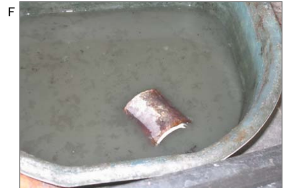
⑥炉から取り出した筒と歯(リング)のつめものを外す水洗い場。筒(リング)とボロボロになった石綿リボンが残り、それを水洗します。水洗い場の周囲には粉じんが乾燥して白い粉としてこびりついています。
