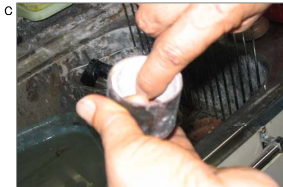
③石綿リボン作業。歯科技工の作業では石綿リボンをよく使っていました。写真は歯のつめもの作成の際に使用する筒(リング)の内部に石綿リボンを貼り付けているところです。
