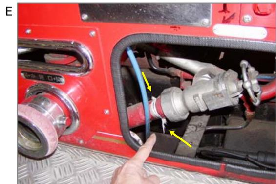
ポンプ車。圧力をかけますので、ゆるいネジ山や継ぎ手があれば水が漏れてしまいます。そこで以前は、石綿糸やテープが使用されており、補修・交換時にばく露する可能性があります。
