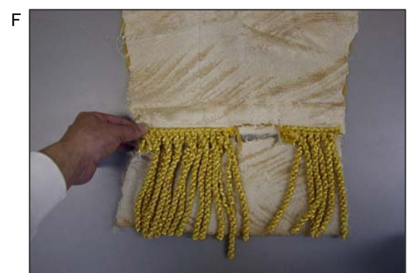
F 劇場などの緞帳。舞台での花火手品から着火したことがあり繊維の一部に石綿を混入して防火性能をもたせたものがありました。また、天井に石綿吹きつけがあり、粉じんが付着している可能性はあります。
