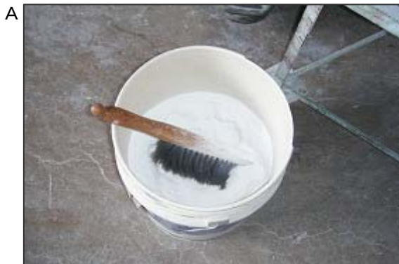
A タルク入りのバケツにハケが入っています。タルクにはしばしば石綿が不純物として混入していました。
