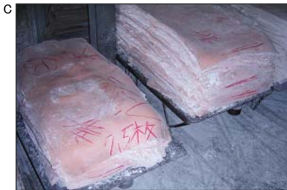
C 加工用ゴムです。この工場では、このようなゴム板を製造し、靴底等に加工する工場へ出荷します。運搬する際にも、タルクが飛散した可能性があります。
