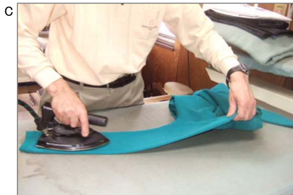
C クリーニング店といえばやはりアイロン。昔のアイロンはもっと重くてごつかったそうです。そのアイロンの熱絶縁部に薄い石綿板が使用されていました。分解しなければ、ばく露の可能性はありません。
