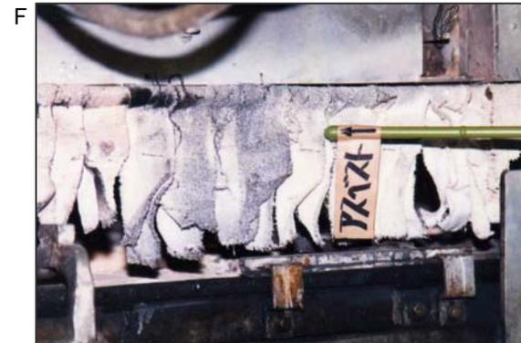
炉内覗き窓の周囲の石綿布。ガラスの加熱状況を覗く窓にすき間があり、そこから室内へ熱が逃げるため、そのすき間を覆うように石綿布をかけてあります。必要な際に、布をめくって中を覗きました。布の劣化によりばく露の可能性があります。
