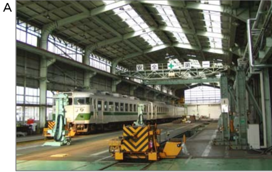
【作業環境】車両検査場・修理場。安全運行には点検、部品交換など整備は重要です。レールの下にはピットがあって下からも覗けます。建物はスレート葺き屋根・壁のものもあります。
