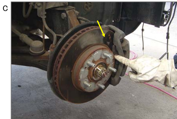
C 自動車のブレーキパッド。以前は、鉄粉、石綿その他混和材を入れディスクの磨耗の低減および制動効率のアップを図りました。修理・交換時に、摩耗して堆積した石綿含有粉じんがばく露した可能性があります。
