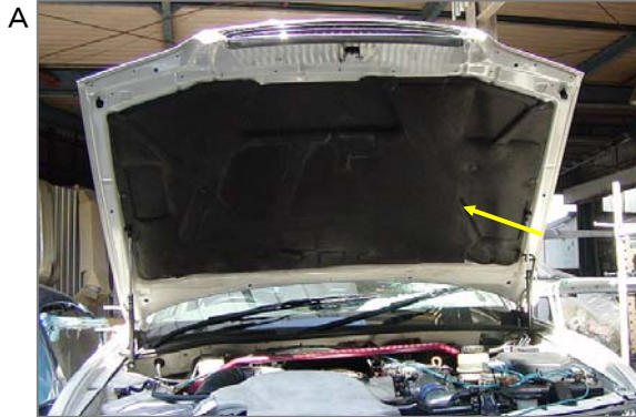
A 自動車修理工場。以前、特定の車種には、ボンネット裏にエンジンからの放熱による色落ちを防止する目的で石綿フェルトが張られているものがありました。取付け時、修理時に作業員がばく露した可能性があります。
