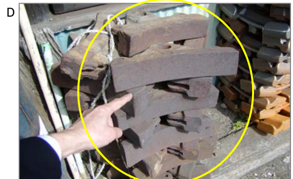
ブレーキシューはおよそ3ヶ月程度で交換とのこと。過去の修理・交換・解体時に摩耗し付着した粉じんにはばく露した可能性があります。
