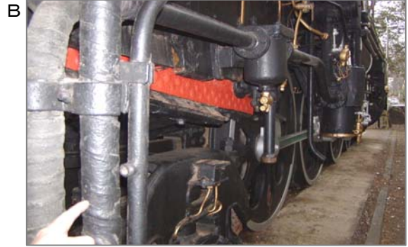
蒸気機関車はボイラー本体を積載しています。そのボイラー周囲の断熱材や派生する配管には石綿テープが巻かれ、省エネ、運転室での乗務員のヤケド防止に有効です。
