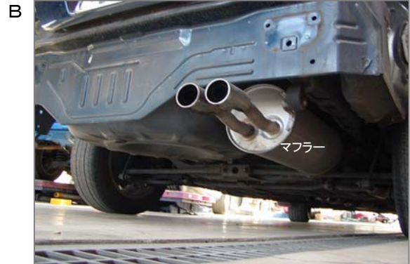
B 同じくマフラーには、高熱になる排ガス熱の断熱目的で、断熱材を内張りしているものがありました。この他にクラッチフェーシング(駆動系に用いる摩擦材の一種)にも石綿が含有されていました。
