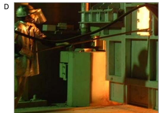
製鉄・製鋼の巨大な装置類は、炉内も含め全周石綿含有保温材で被覆されているといえます。このほか建物内の石綿吹きつけやスレート製品なども多用されています。
