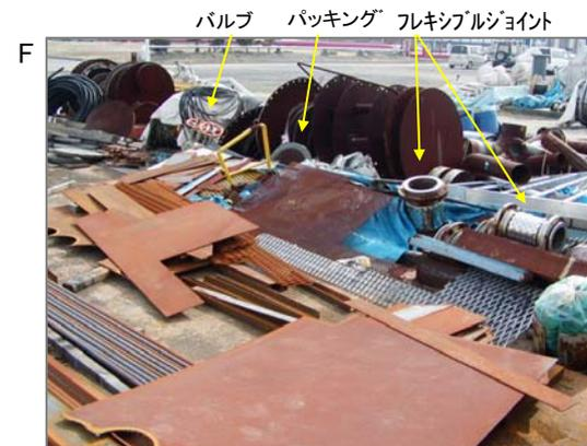
工場の片隅にある造作野丁場。フレキシブルジョイント(配管の継手)やバルブ(開閉のためのハンドル、配管との接合部に石綿パッキングを使用していたことがある)、石綿パッキングなどが雑然と置かれています。劣化により飛散の可能性があります。
