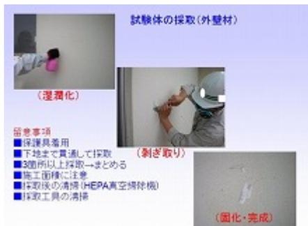
図-4 サンプルング例 (外壁材)
