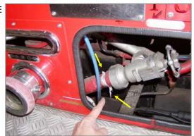
ポンプ車。圧力をかけますので、ゆるいネジ山や継ぎ手があれば水が漏れてしまいます。そこで以前は、石綿糸やテープが使用されており、補修・交換時にばく露する可能性があります。
