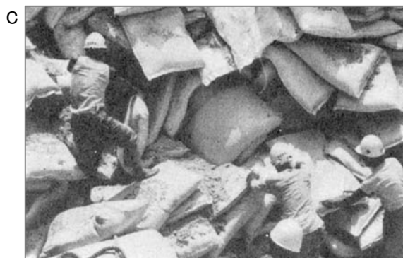
③はしけ内の石綿荷役作業。通称「まくり返し」と呼ぶ乱雑な荷さばきで手鉤により破れた袋が多くありました。破れた箇所から石綿が飛散し、作業者がばく露した可能性があります。
