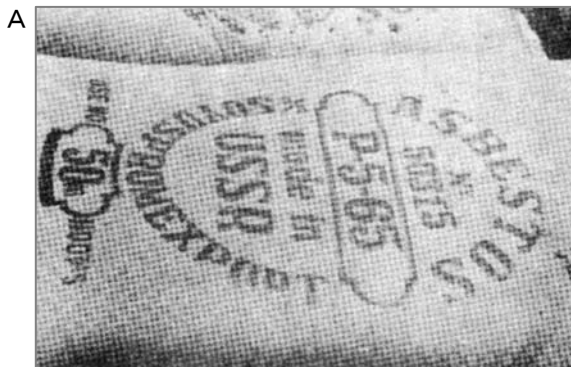
①1970年代前半の石綿が梱包された麻袋。この他に石綿が露出されたままでベルト巻きしたのもありました。これらをモッコ(網)やスリング(ワイヤー)で吊り上げる方法で荷役しました。
