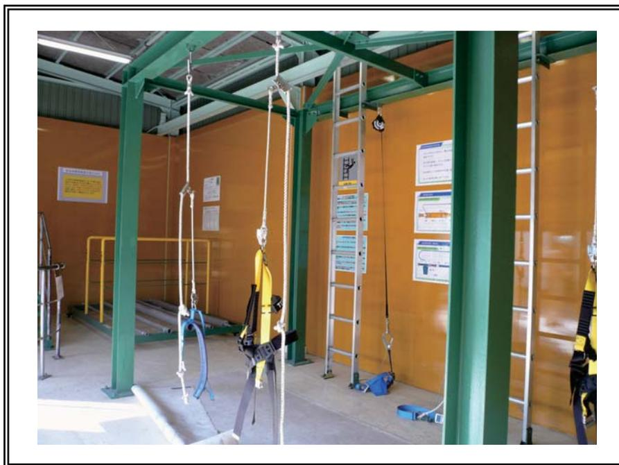
図 7. 6 安全帯使用の体感をさせるための施設
