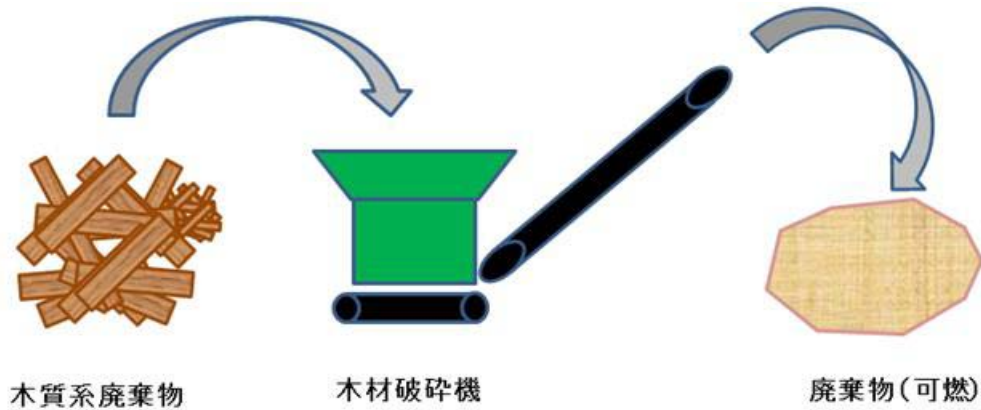
図-2 木質系廃棄物の木材破砕機によるチップ化処理
