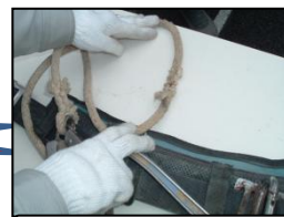
安全帯の点検 ※7
