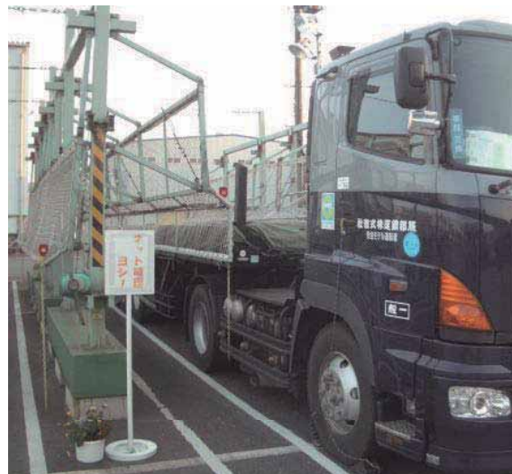
図 4-35 墜落防止柵を使用した状態（作業時）
