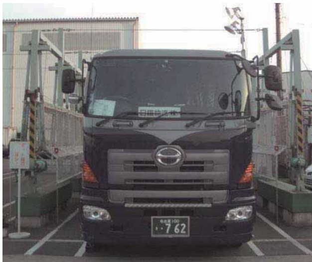
図 4-34 墜落防止柵を使用していない状態
