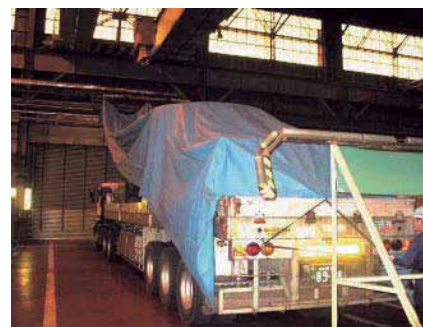
図 4-15 シート掛け完了寸前の状態
