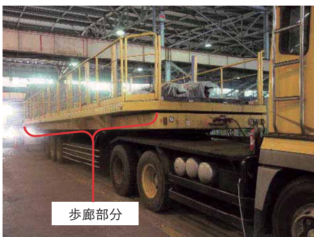
図 4-25 トレーラー歩廊部分
