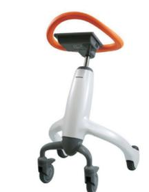
歩行器型のロボット。押して歩くだけで、トレーニングの結果が自動で計測・記録され、介護事業者・施設など向けに、一人ひとりに合った歩行機能訓練をサポートするサービスを提供している。
