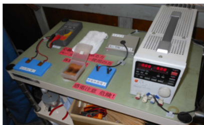
写真 2 感電体感装置
