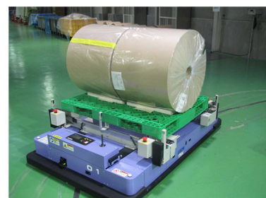
写真3 重量物運搬ロボット
