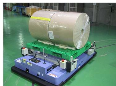
写真3 重量物運搬ロボット
