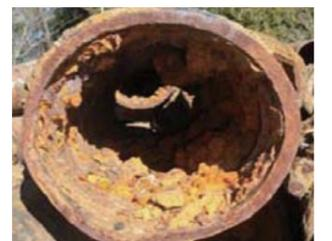
[水道管の経年化による内面腐食]
