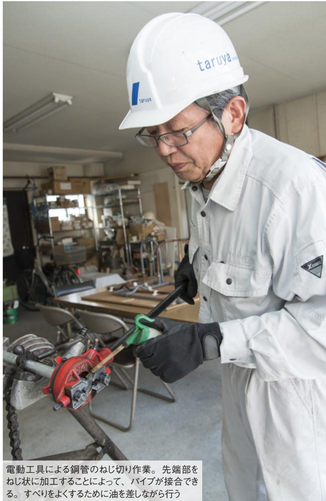
電動工具による鋼管のねじ切り作業。先端部をねじ状に加工することによって、パイプが接合できる。すべりをよくするために油を差しながら行う
