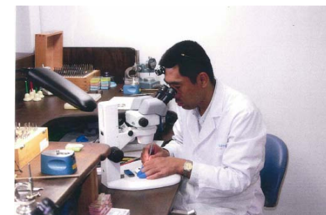
時計組立作業台にてソヌリ機構の調整作業
