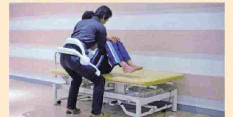
装着型パワーアシストを用いて、介護者の介助を支援
