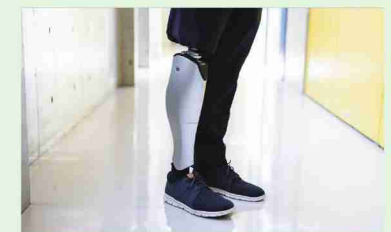
障害者自立支援機器等開発促進事業で開発した下肢切断者の足の動きを補助するパワード義足
