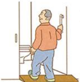
(柔らかいゴム製品もあります) 室内のわずかな段差、床と敷居の段差解消に「スロープ」を設置
