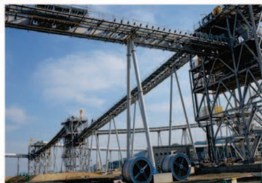
盛土用の巨大なベルトコンベア。
