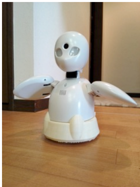
図2 可動式台座完成イメージプロトタイプ
