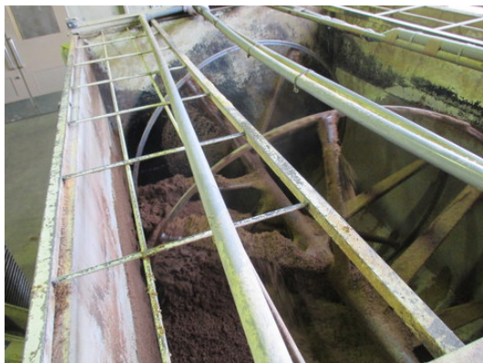
菌床の原料のおがくずと栄養体が混ざられている様子
