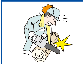
小型チェーンソーにタオルが 巻き込まれそうになった
