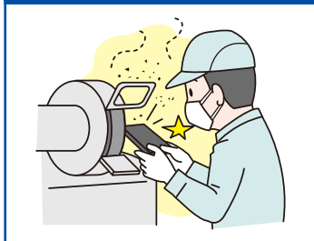
高速回転砥石切断機による鉛ヒュームで慢性鉛中毒
