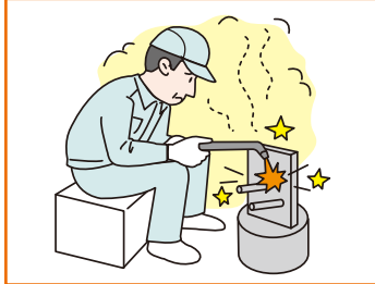
含鉛塗料が塗布された鋼材の溶断で鉛中毒
