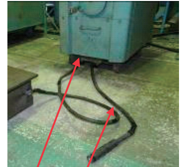
ぜつえん じょうたい かくにん ぶ い 絶縁状態確認部位 ようせつ き 溶接機、ケーブル、ホルダ
