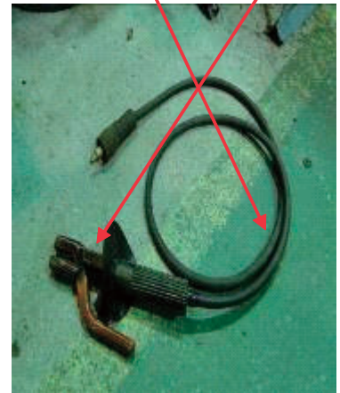
ぜつえん じょうたい かくにん ぶ い 絶縁状態確認部位 ようせつ き 溶接機、ケーブル、ホルダ
