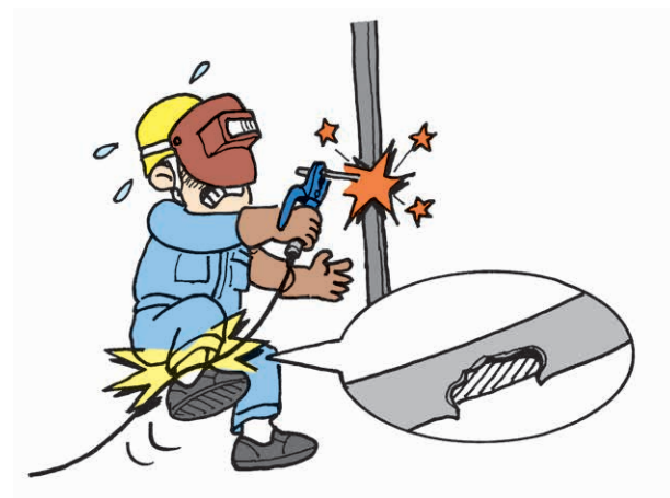
Điện giật do dây điện thứ cấp của máy hàn hồ quang lộ ra
