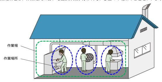
製造炉等がある屋内作業場において、例えば三酸化二アンチモンの包装作業を行う場合は、製 造炉等の例外規定による措置を講じるときであっても、包装作業の発散源には局所排気装置等の 設置が必要です(特化則第5条第1項)。
