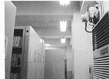
カルテ室—無人だが空調に気を遣い、天井に調湿目的の吹付け材が施工されている
