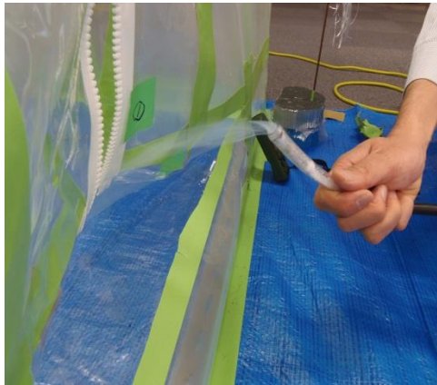
図-37 スモークテスターによる確認
