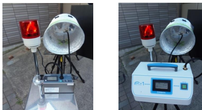
図－47 排気ダクト内の測定時に警告灯を設置した例
