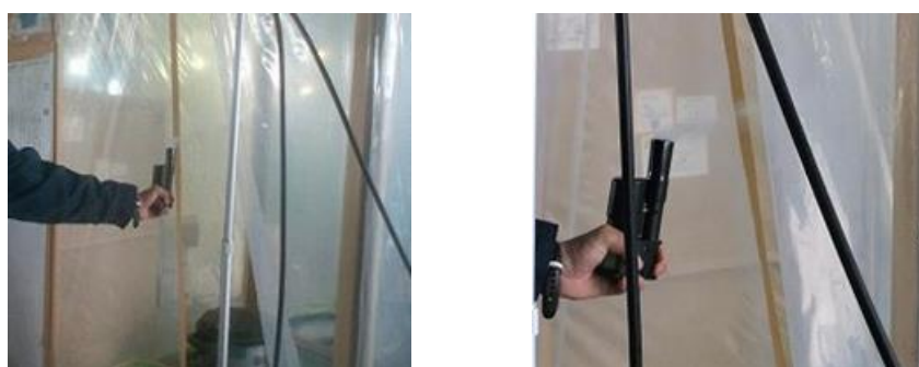
図－35 セキュリティゾーンの入口の気流方向の確認
