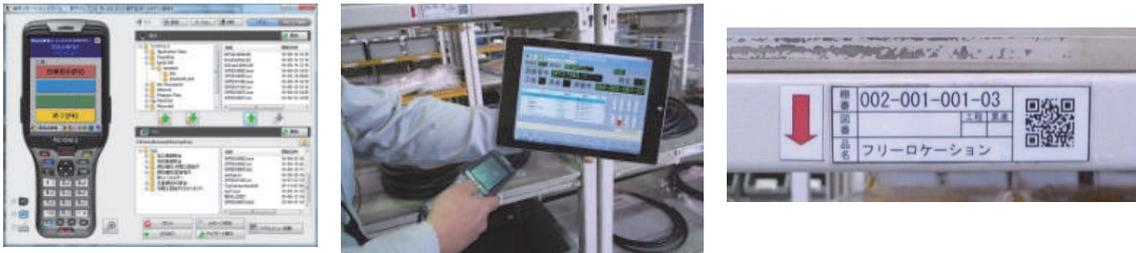
また、各部品棚をタブレットの中で行と列で管理することで部品をピッキングする際、機種仕様票の情報を読み取ることで、部品棚のレイアウトから最短距離になるよう自動で並べ替えられ、次にピッキングする棚を赤色で表示することで見える化し、歩行ロスを削減した。
