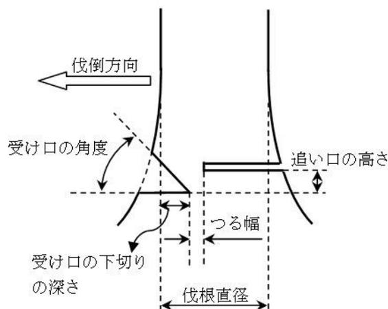
図 2 伐倒作業に係る寸法
