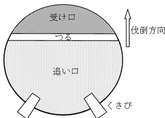
図3 くさびの打ち込み位置の例
