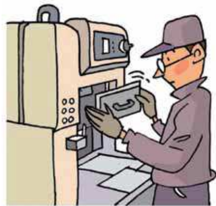
裁断用の刃を交換しています。
