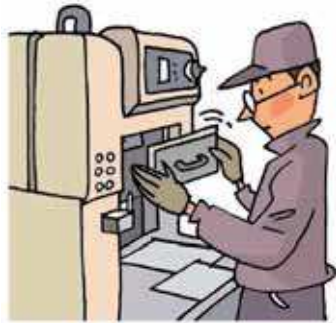
④印刷製本作業（断裁（刃・包丁交換）
