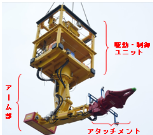
▲装置全景 (クレーンで吊り下げて使用) 重量：約18t 駆動装置：油圧
