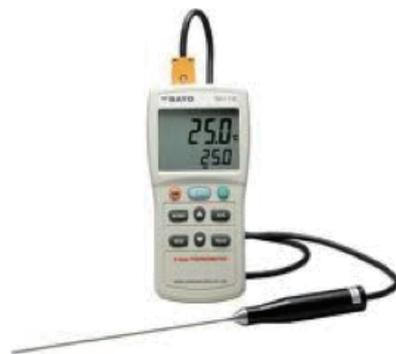
① 3本以上の温度計で表示温度を確認する。全ての温度計が同じ温度を表示すれば「問題なし」とし、ずれているものは「問題あり」とします。
