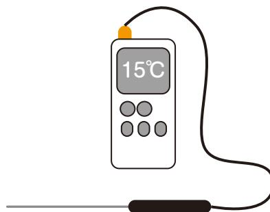
①3本以上の温度計で表示温度を確認し、全ての温度計が同じ温度を表示すれば「問題なし」とし、ずれているものは「問題あり」とします。
