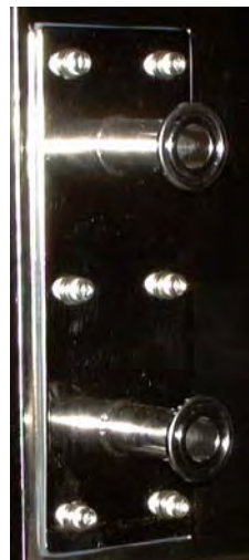
試料導入/排出部 ヘルールジョイントの例
