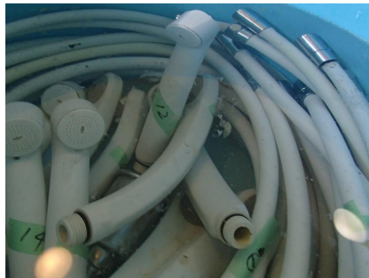
シャワーホースから剥離したバイオフィルム(水道水使用)
