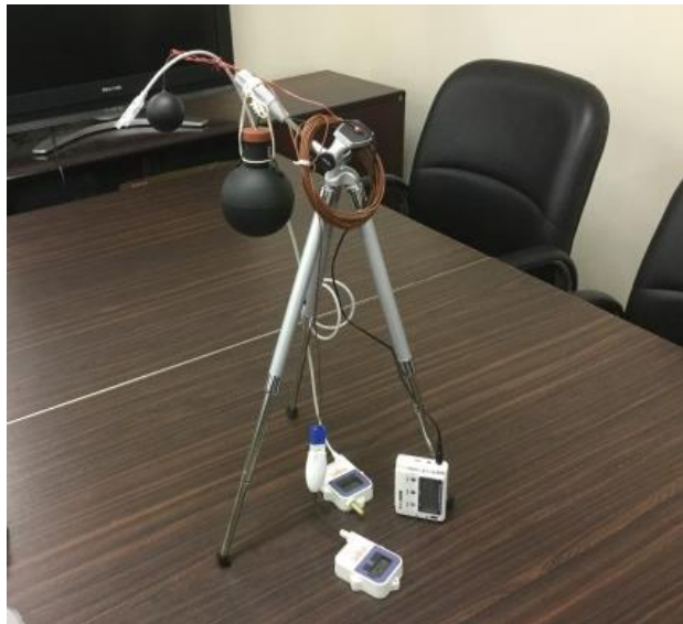
環境4要素(温度, 相対湿度, 気流速度, 平均放射温度)の測定
