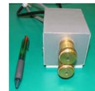
図2 双極性防爆構造除電器
