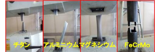
〈代替材料候補における強度試験（引張）〉
